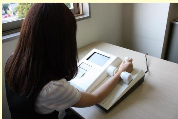
手首の骨波形を測定し、音の伝導速度などから骨の強度を推測して、5段階で表示します。
